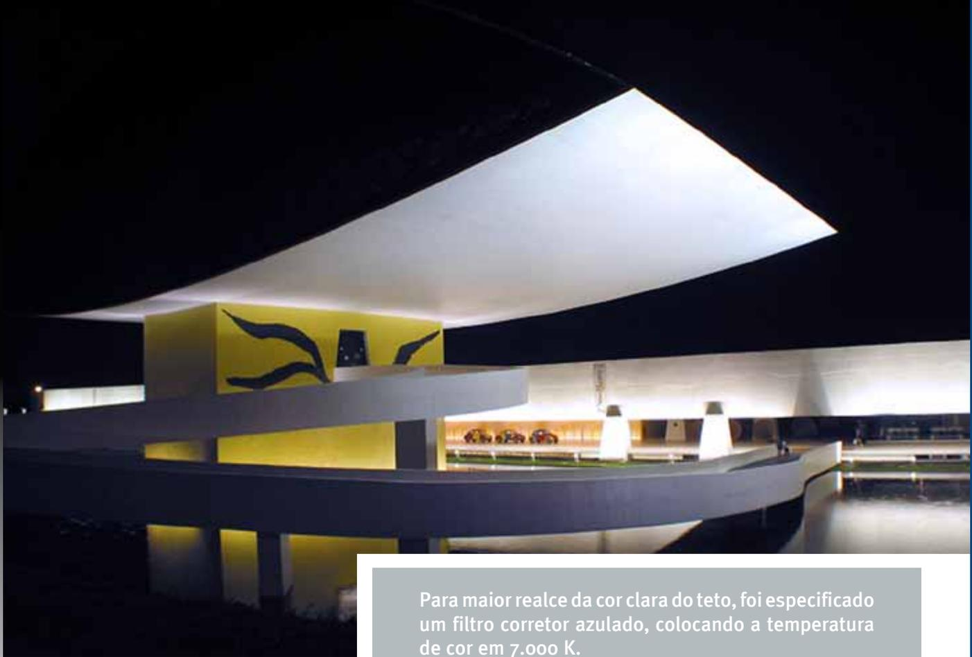
Para maior realce da cor clara do teto, foi especificado um filtro corretor azulado, colocando a temperatura de cor em 7.000 K.
